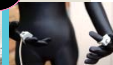
両指に装着するダブルマウス。キーボード代わりに使う
