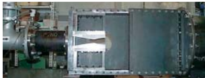
マッハ単位のジェット気流を発生させる超音速風洞
