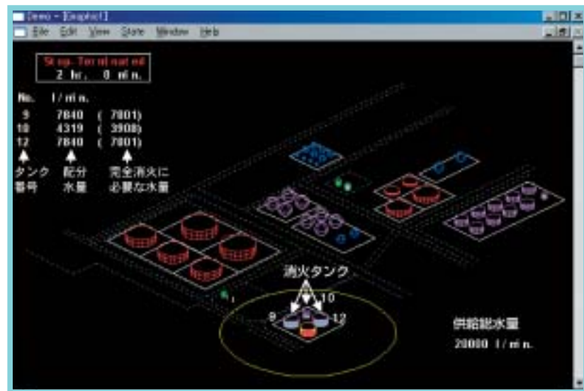
スプリンクラー消火を施すと被害の拡大を防ぐことができる (1分間に2万リットル=消防車7台分=放水した場合)
