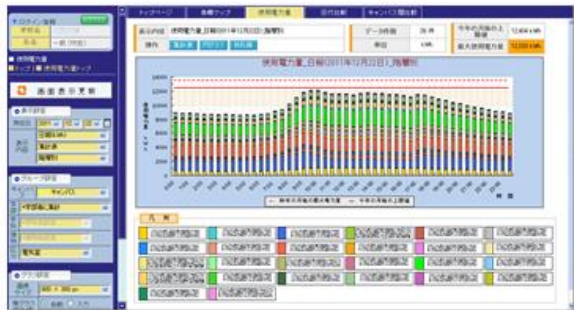
図 1.3 イン트라ネット上の電力可視化システム画面② (グラフ表示例：計測間隔 30 分) ⇒建物ごとの電力使用量をリアルタイム表示
