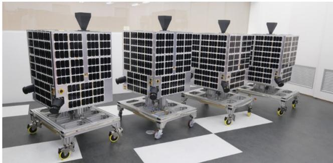
概要：AxelGlobe は、質量約 100kg の超小型光学観測衛星 GRUS を多数軌道に配置し、地球上のあらゆる場所を毎日観測する、次世代地球観測プラットフォームである。GRUS は従来の衛星より小型でありながら、高品質な地上分解能 2.5m の光学画像撮影が可能である。現在は衛星 5 体制で 2～3 日に一度、同一地点を観測でき、2023 年までに 10 機体制を実現させることで世界の毎日観測を可能にする予定である。
