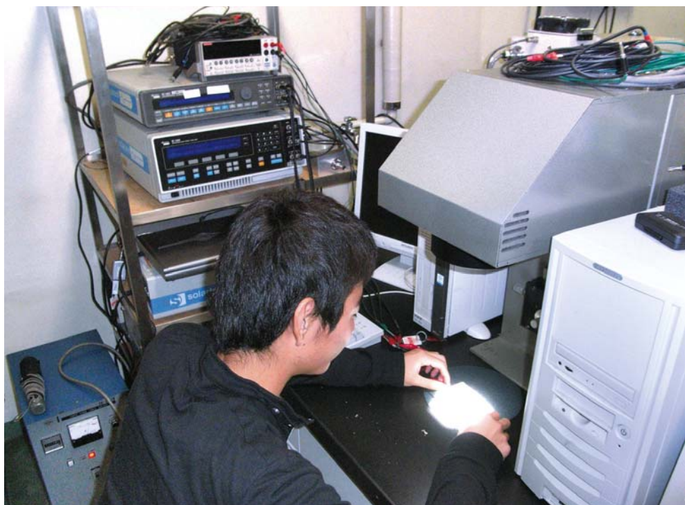
擬似太陽光を使って作製した 太陽電池の変換効率を測定
