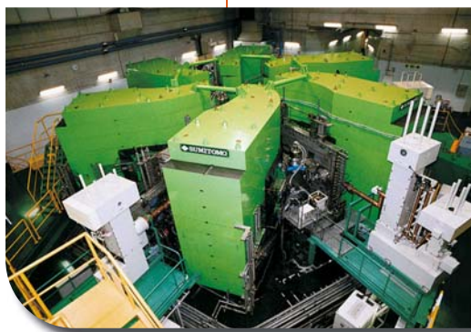
大阪大学核物理研究センターの原子核の内部を探る装置、リングサイクロトロン。陽子などの粒子を光の速さの3分の2もの速さに加速する。
