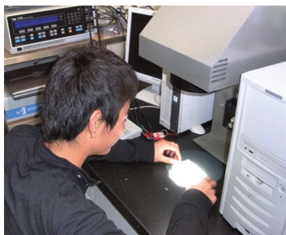
擬似太陽光を使って作製した太陽電池の変換効率を測定
