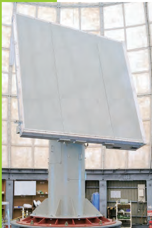
下の白いレドーム内に格納されたフェーズドアレイアンテナ
