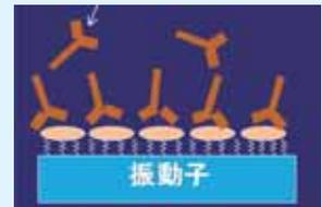
鳴り響く振動子表面に標的タンパク質を吸着させ、振動子の見かけの質量を増加させると共振周波数が低下する。この原理を用いて吸着したタンパク質の質量を検出するセンサーが振動子バイオセンサーである。
