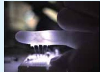
人間の指を近赤外光を使って撮影すると静脈などが透けて見える。しかし、内部では光が散乱するため、鮮明化のためには散乱成分除去が必要となる。
