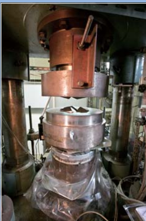
アンビルは高圧装置の心臓部に組み込んで使用される
