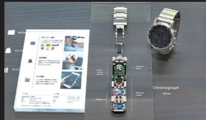
腕時計のバンド部分にスマートウォッチとして必要な機能、電池などを集約
