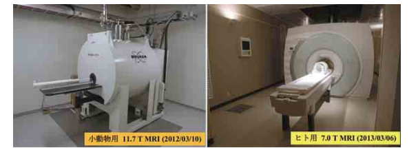
IFRECに設置された小動物用11.7T MRI CiNetに設置されたヒト用7.0T MRI
