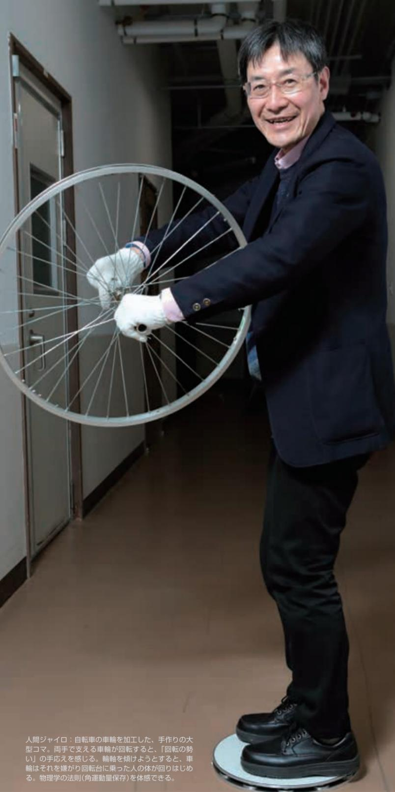
人間ジャイロ：自転車の車輪を加工した、手作りの大型コマ。両手で支える車輪が回転すると、「回転の勢い」の手応えを感じる。輪軸を傾けようすると、車輪はそれを嫌がり回転軸に乗った人の体が回りはじめる。物理学の法則(角運動量保存)を体験できる。
