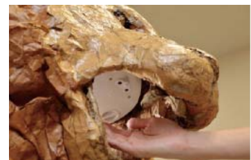
ライオン型手指消毒器：「真実の口」をアレンジしたもの。ライオンの口に手を入れたくなり、手を入れるとアルコール消毒液が噴射される仕組み
