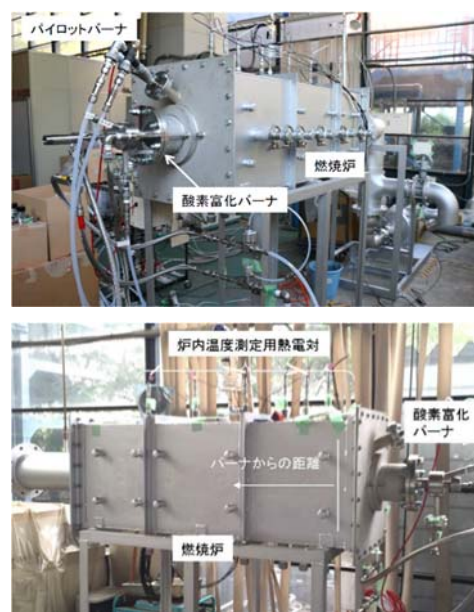
10kW モデル燃焼炉
