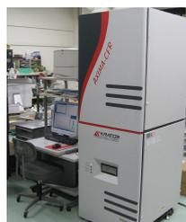
マトリクス支援レーザー脱離イオン化飛行時間型質量分析計
