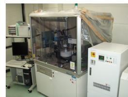
極微小結晶用X線構造解析装置
