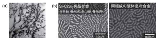
図2 (a) 液相焼結した Si-CoSi 2 (b) Si-CrSi 2 共晶組織
