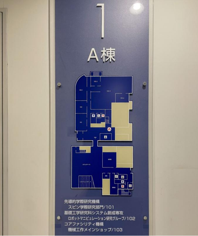
反射の低い素材を用い、高いコントラストで表記することで視認性を確保することができる。
