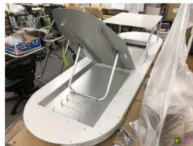
(アイソレーターのカバー部分が完成しました。患者の足元に人工呼吸器等を置く台を配置、リクライニングは4段切り替えることができます。完成後はマットレスを敷きます。)
