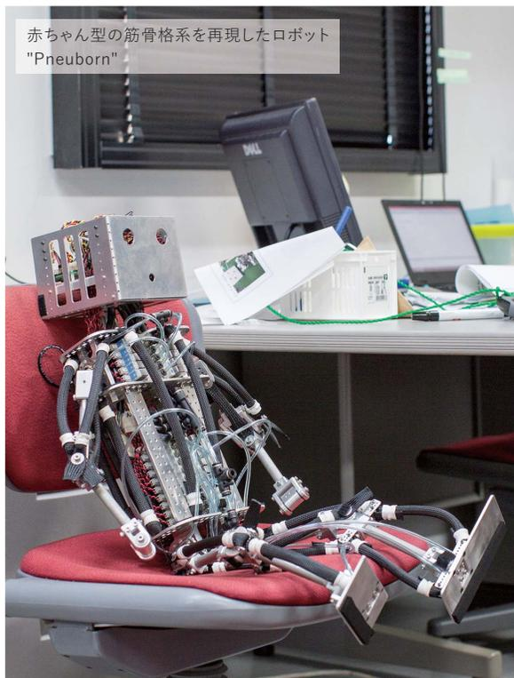
赤ちゃん型の筋骨格系を再現したロボット "Pneuborn"
