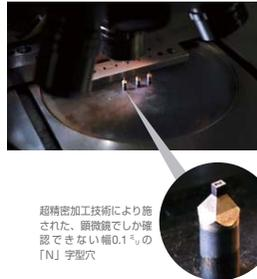
超精密加工技術により磨かれた、顕微鏡でしか確認できない幅0.1μmの「N」字型穴
