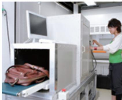
手荷物検査装置の試作機。NQR技術を利用することによって、瞬時に不正薬物を検知することが可能
