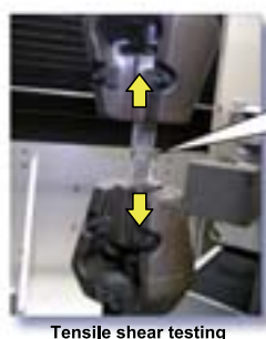
◆LAMP接合部の強度を引張せん断試験により評価し、試験中の観察により破断発生位置を特定している。
