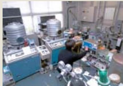
有機薄膜太陽電池の作製装置
