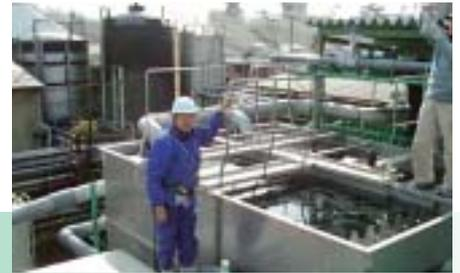
大阪市内の再生紙工場の第1号機(沈殿槽の写真、3m×4m×2.5m)
