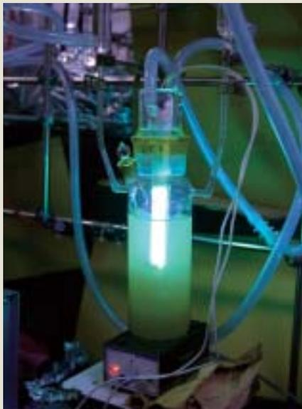
光触媒を用いた人工光合成の実験
