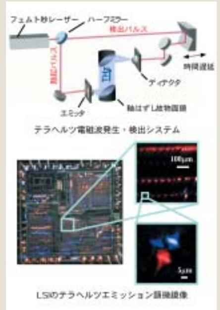
斗内研究室では電子材料にフェムト秒レーザーを照射し、テラヘルツ電磁波が放射される原理を使って、顕微鏡の開発に取り組んでいる。これも世界で類例のない研究で、極微細・複雑化してチェックの手立てがないとされているLSI（大規模集積回路）の不良解析やCPU（コンピュータの演算装置）観測が可能とされ、今後の展開が注目されている。
