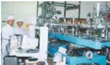
ソフトエラーに強い半導体LSIの試作品の精度を検査する装置
