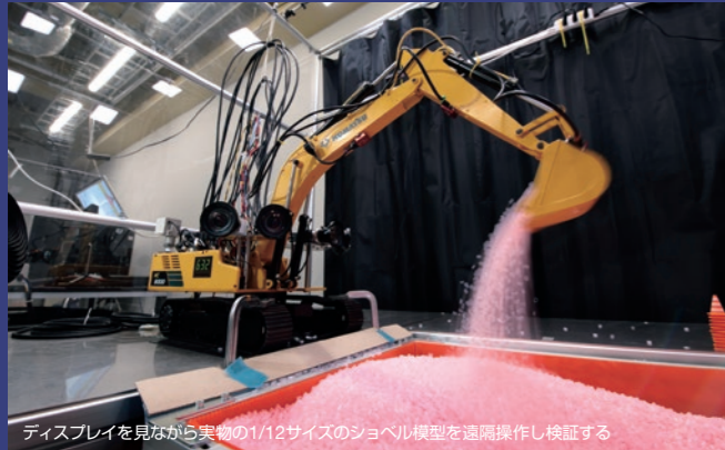
ディスプレイを見ながら実物の1/12サイズのショベル模型を遠隔操作し検証する
