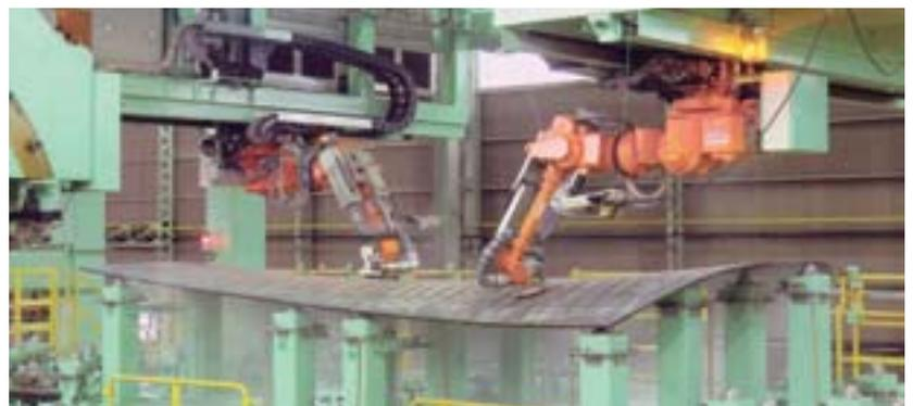
鋼板曲げ加工の全工程を自動で処理できる「全自動線状加熱曲げ加工システムIHIMU- $\alpha$ 」2号機
