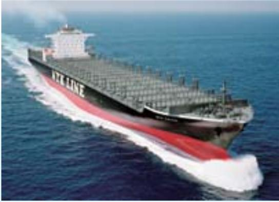
コンテナ船(上)と波の造波抵抗を打ち消す船首の球状突起バルバスパウ(右)。IHIMU- $\alpha$ の技術が生きている
