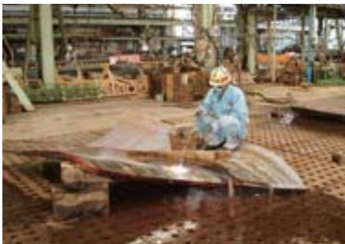
従来の鋼板曲げ加工。熟練技能者がガスバーナーの「線状加熱」と水冷却を繰り返し、曲面を自在に加工する
