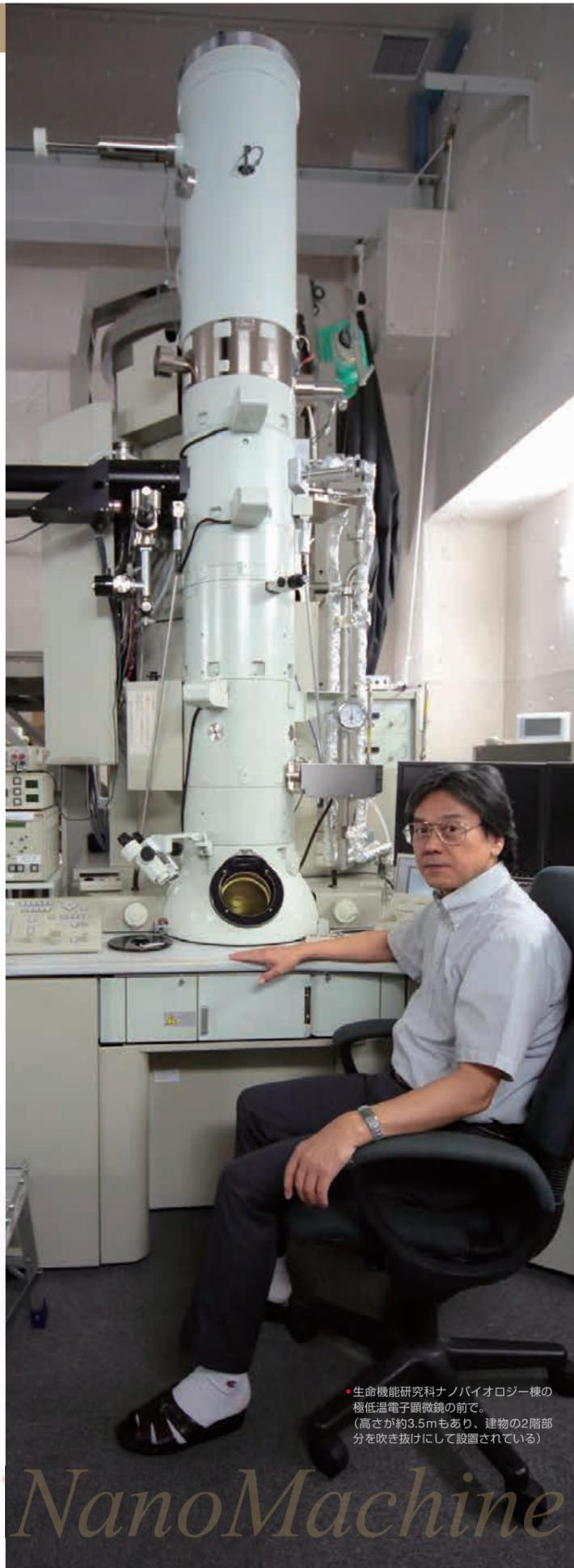
● 生命機能研究科ナノバイオロジー棟の極低温電子顕微鏡の前で。(高さが約3.5mもあり、建物の2階部分を吹き抜けにして設置されている)
