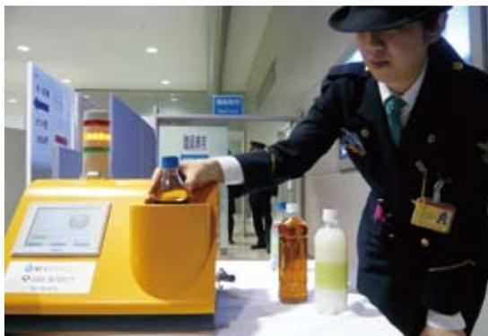
関西国際空港で実証実験に用いた近赤外光液体爆発物検知装置
