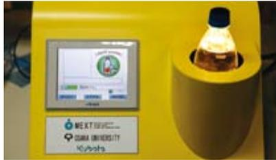
物質には特定の波長の光を吸収したり、吸収しなかったりという固有の性質があり、吸収光のスペクトルの違いから内容物を特定することができます。一般に吸収スペクトルを利用した検査機器には中赤外光を利用する場合が多
