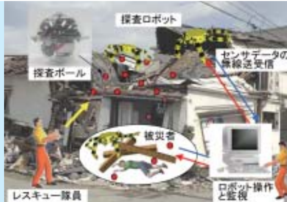
レスキュー作業に適用されるアスタリスクと探査ポール（探査ポールは非駆動タイプの人間探査用センサ）
