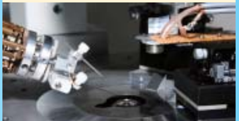
マイクロハンドはAFMと組み合わせて微小力の計測や制御も可能
