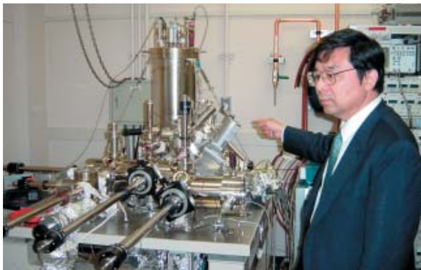
絶縁体の上で2種類の原子を動かして超微粒子を組み立てる装置 「絶縁体の上」も「2種類の原子を動かす」のも、それで「超微粒子を組み立てる」のも世界で初めて。
