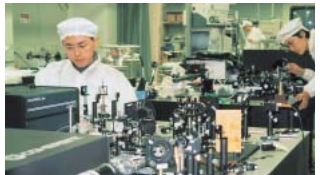
レーザー光線を使って光機能材料の性能を評価する(高分解能非線形光学現象測定システム)
