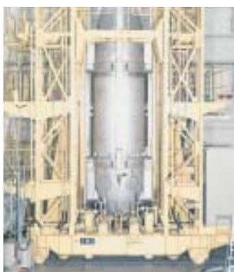
実験装置を組み込んだ落下カプセル（外カプセル内真空の二重カプセル構造）。ミノムシは落下立杭（深度710m）へのキャリアーに載せられている。
