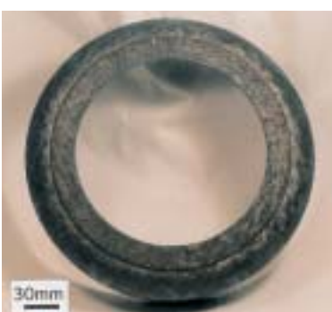
高温まで超強度・超靱性の長繊維強化ナノ複合材料で作製した高効率ガスタービン部品
